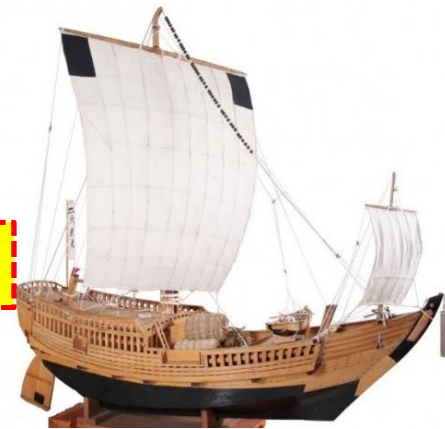
和船(平底・棚板構造)
