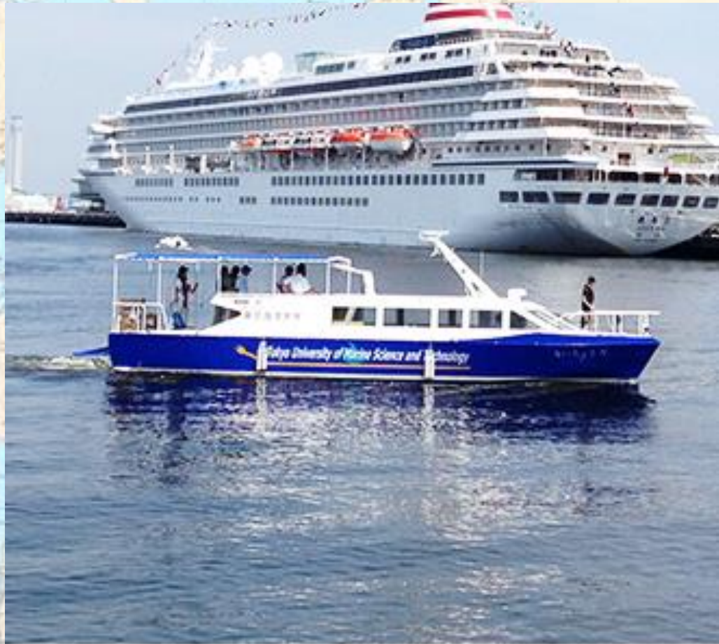
横浜で実験中の電池推進船
