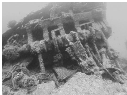
滝之浦海底の蒸気レシプロの残骸。コネクティングロッド 3 本。
